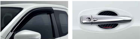
Door Visor กั้นกันสาดประตู Door Handle Protector กันรอยมือเปิดประตู ลายคาร์บอน หมายเหตุ: อุปกรณ์มาตรฐานในภาพโฆษณาอาจแตกต่างกันไปตามรุ่น
