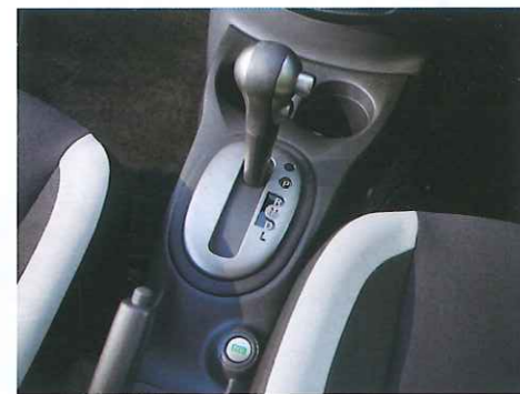
Xtronic無段變速CVT波箱，配合停車熄匙系統，油耗低至$0.59/km。
