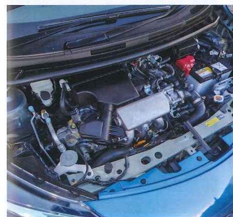
1.2公升3汽缸supercharge引擎，馬力98匹，扭力14.5kgm，同級最慳油又有力。
